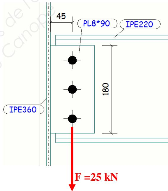
**Q.11.** Calculer, au centre de la soudure, le moment d'excentrement induit par l'effort de 25 kN.
