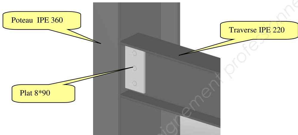
L'attache est représentée sur la figure ci-contre. Un effort  $F$  calculé à l'ELU, d'une intensité de 25kN, est situé au droit des boulons.
