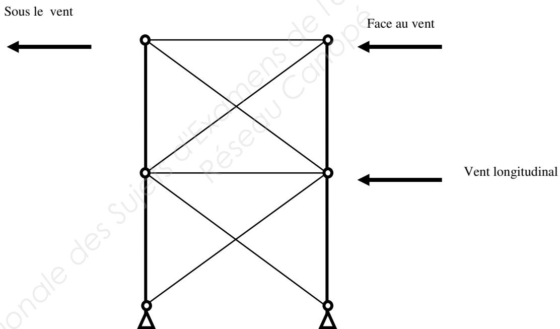
**Q.6.** Reproduire le schéma ci-dessus sur feuille de copie et indiquer quelles sont les barres comprimées et les barres tendues sous l'action du vent WL, en respectant la légende ci-dessous :
