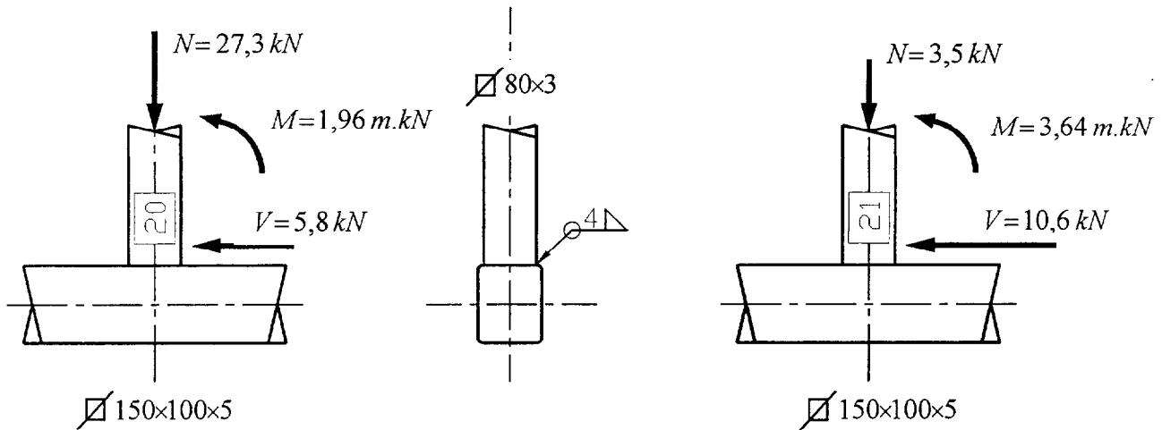
Le cordon de soudure, d'épaisseur utile  $a = 4$  mm, est un cordon périphérique.
