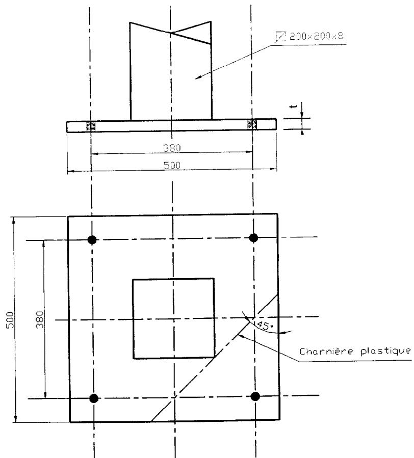
On envisage la situation provisoire avant réalisation du mortier de calage. La platine repose donc sur les 4 tiges d'ancrage uniquement, conformément à la figure donnée dans le document de présentation 4/4 du dossier technique.
