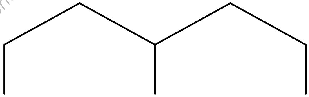
Diagramme de moment fléchissant - échelle 1 mm pour 1 kN.m
