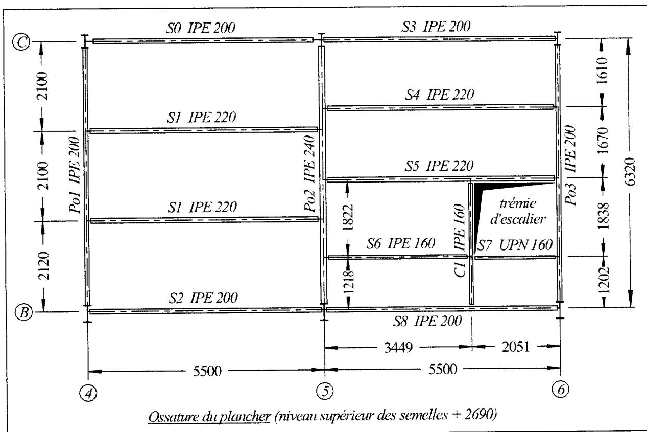
Les poutres porteuses  $Po1$ ,  $Po2$ ,  $Po3$  et la solive de rive  $S0$  sont en liaison rigide sur les poteaux.
