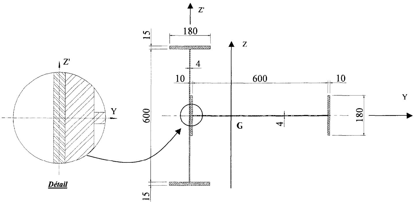
La section du poteau est composée de 2 I (PRS) suivant le schéma ci-dessus.
