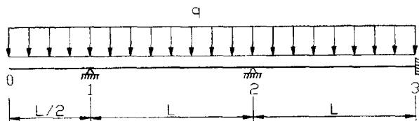
2.1/ Justifier le choix du modèle simplifié en rappelant les propriétés et particularités : de la structure, du chargement, des actions aux appuis, du diagramme de  $V$ , du diagramme de  $M$ , des déformations.
