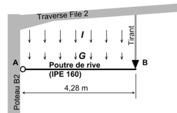
Fig. 3 Schéma mécanique de la poutre étudiée (AB), elle est isostatique et soumise aux charges linéaires uniformes :  $G = 2 \text{ kN/m}$  et  $I = 5,9 \text{ kN/m}$  (ceci est à démontrer à la question 7).
